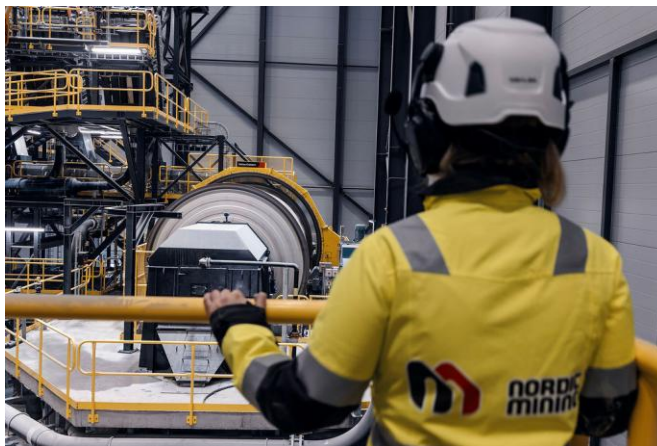
Figur 20 - Oppredningsverk som inkluderer knusing, maling og separasjon av rutil- og granatkonsentrat (Foto: Jostein Vedvik)
