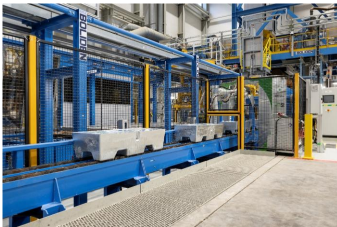
Figur 26 - Transport av støpte produkter ved et helautomatisert sinkstøperi ved Boliden Odda (Foto: Thor Brødreskrift)
