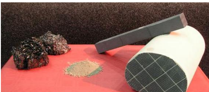
Figur 49 - Silisiumkarbid primærvare, submikron pulver og eksempel på sluttprodukt for bruk i filtrering (Foto: Washington Mills)
