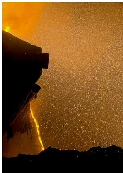
Figur 44 - Tapping av ferrosilisium metall ved smelteverket Finnfjord (Foto: Finnfjord)
