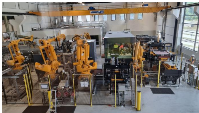
Figur 22 Roboter som håndterer produkt fra den nye elektrolyseprosessen for kobber ved Glencore Nikkelverk i Kristiansand Foto: Enova
