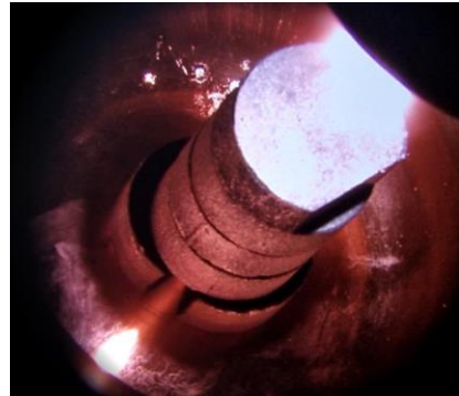
Figur 9 - SINTEF's HyPla-prosjekt bruker hydrogenplasma som erstatning for kull i metallproduksjon, Foto: Sintef
